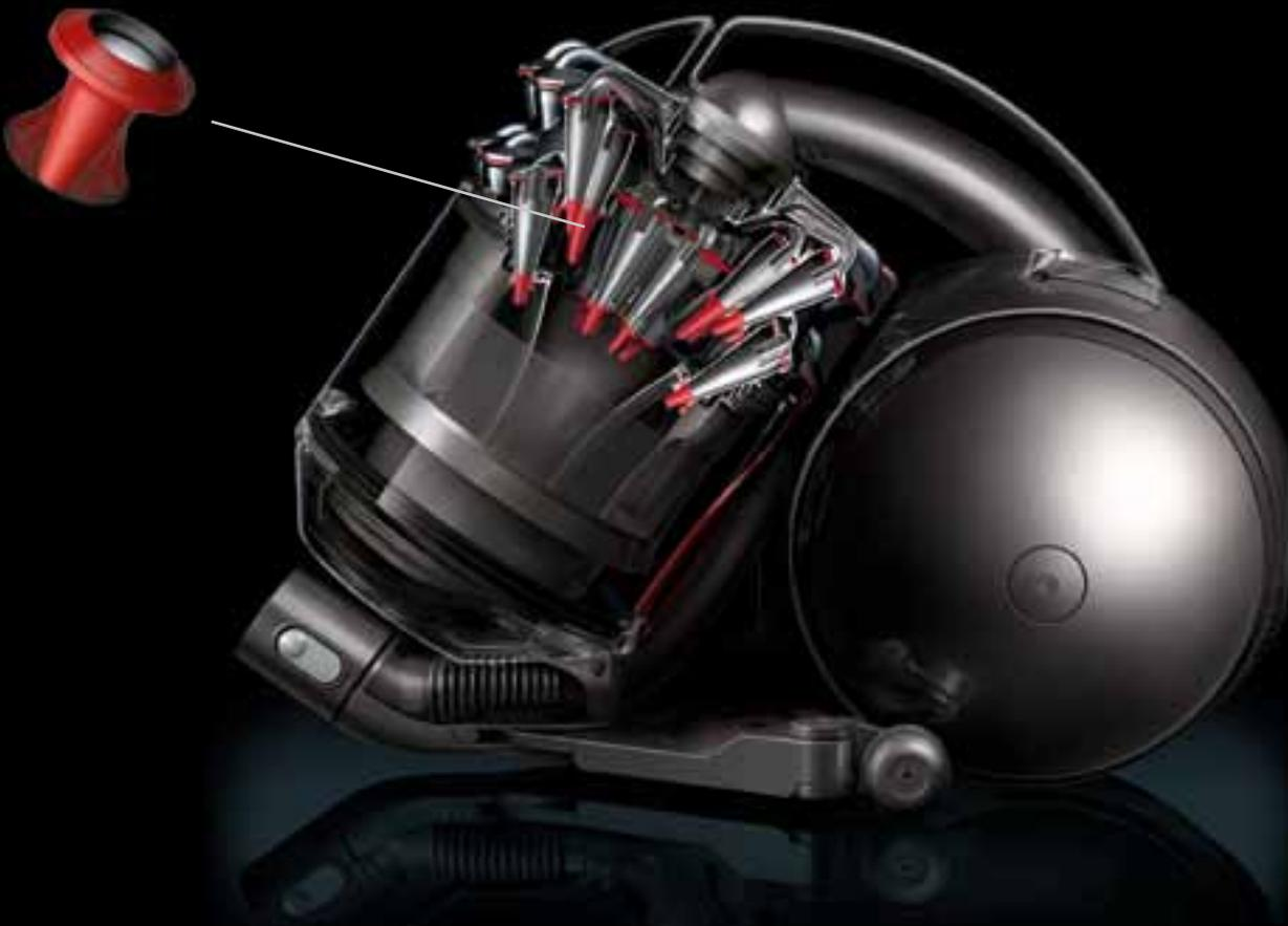
Die 54 Zyklonspitzen des DC52 vibrieren mit einer hohen Frequenz, um ein Verstopfen der kleinen Zyklone zu verhindern. Die Staubtrennung der Zyklone ist so effizient, dass kein Filter mehr gewaschen oder ersetzt werden muss.
